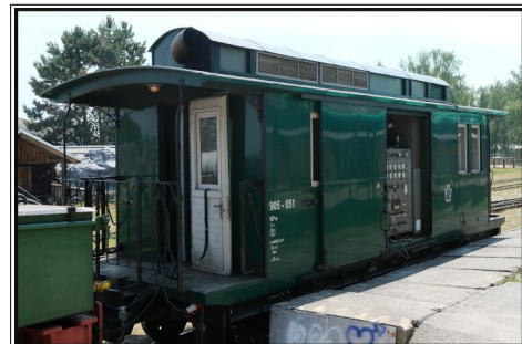
Abbildung 9: Generatorwagen im Bahnhof Haselbach.
